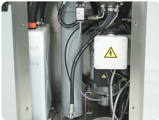
Potente grupo hidráulico. Depósito aceite independiente transparente.
